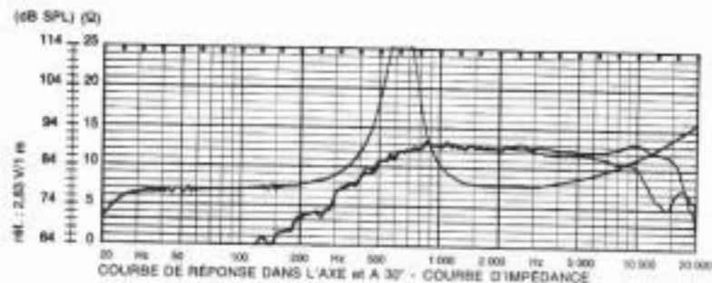
Membrane dôme souple à grande corrugation permettant de bonnes élongations nécessaires à la reproduction correcte du médium jusqu'à vers 700 Hz.
